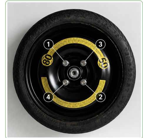
Abbildung 6: Radschrauben über Kreuz lösen
